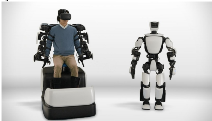
Рисунок 3 – Робот Toyota T-HR3 и костюм телеуправления.
