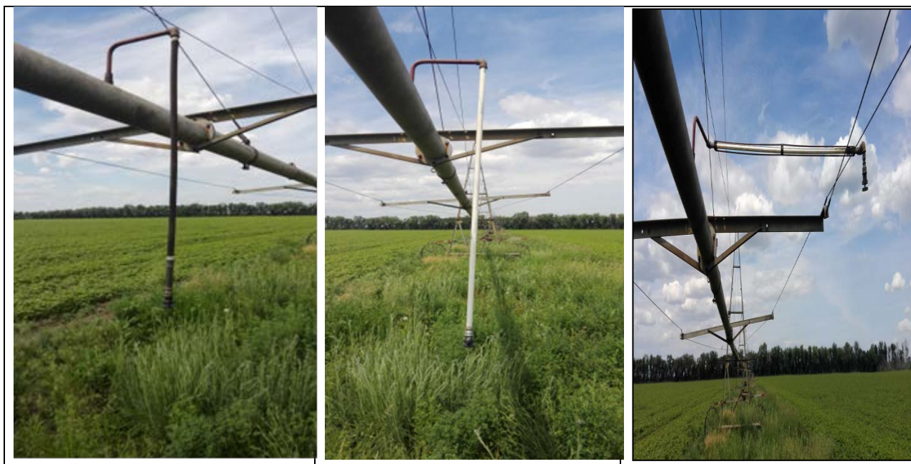
Рисунок 2 – Устройства приповерхностного дождевания: а – сборный рукав; б – сборная штанга; в – поворотная штанга.
