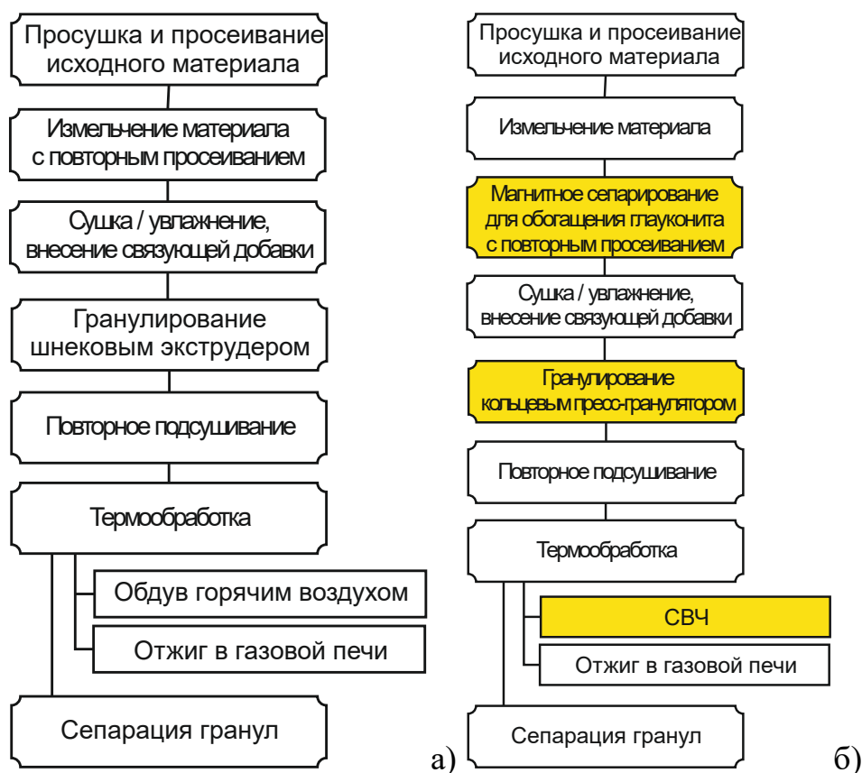
Рисунок 1 – Существующая (а) и предлагаемая (б) технологии гранулирования сорбента на основе природного глауконита.
