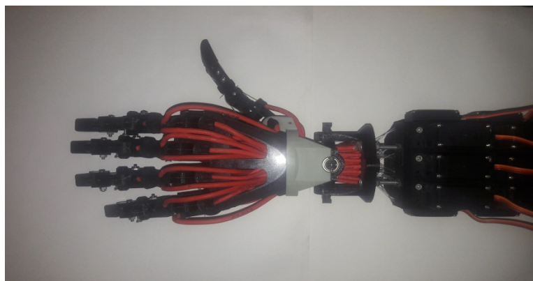
Рисунок 3 – Макет бионической кисти (вид сверху).
